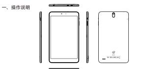
本机开机操作方式为按键操控方式、按电源按键开机、关机功能请用户使用系 统中的关机功能, 只有在特殊情况下采用按键长按进行硬关机, 需注意的是, 频 繁硬关机可能会丢失系统文件会造成系统功能的不稳定。
