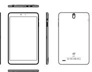
本机开机操作方式为按键操控方式,按电源按键开机,关机功能请用户使 用系统中的关机功能,只有在特殊情况下采用按键长按进行硬关机,需注意的 是,频繁硬关机可能会丢失系统文件会造成系统功能的不稳定。
